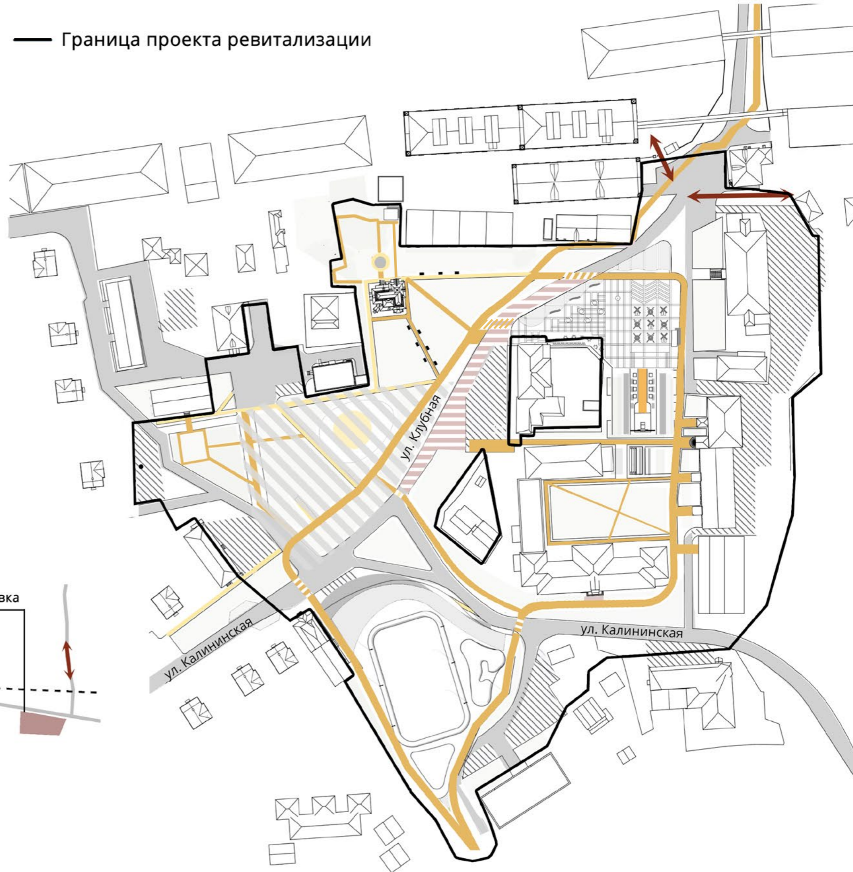
Схема организации движения грузовых автомобилей мукомольного комплекса на погрузку/выгрузку
